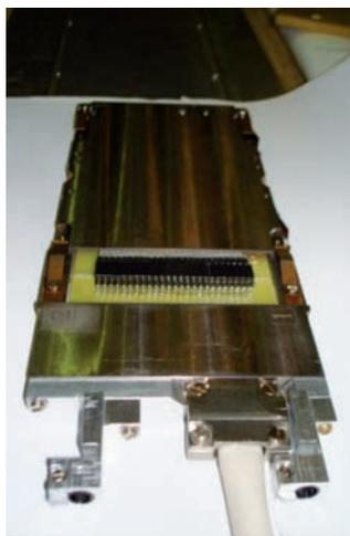
Рисунок 3.9 – Каретка с датчиками холла и отражателями
