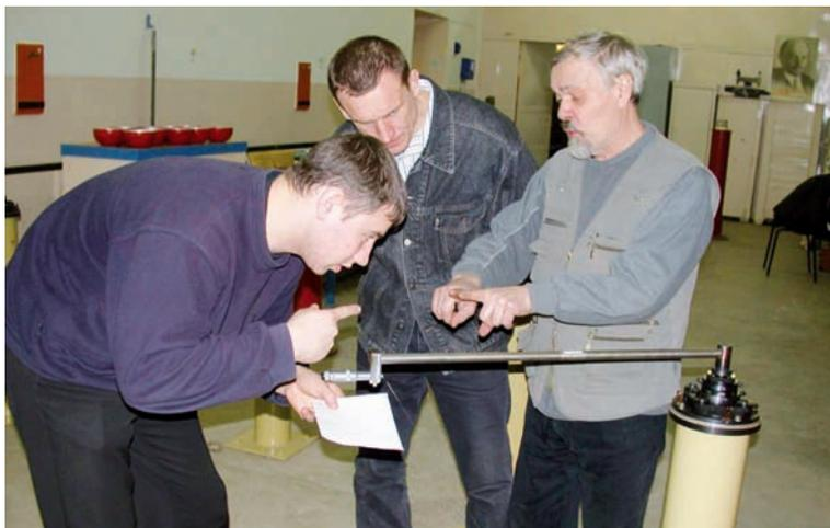
Тренировочные измерения с помощью инварных лент и мерных жезлов ауд. 31 (НИИГАиК-СГГА-СГУГиТ)
