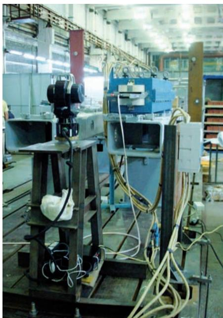
*Рисунок 3.13 – Закрепление лазерного трекера
