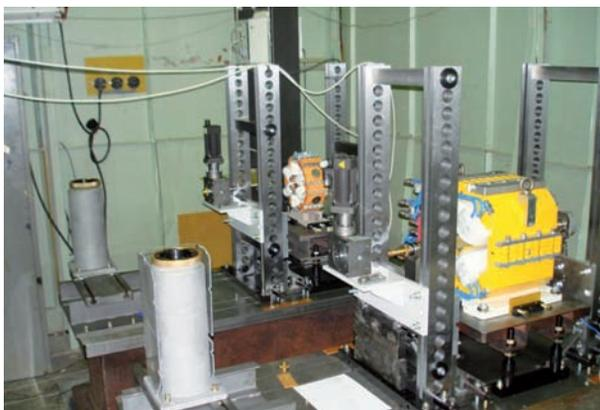
Рисунок 3.17 – Стапеля с квадруполем (ближний стапель)
