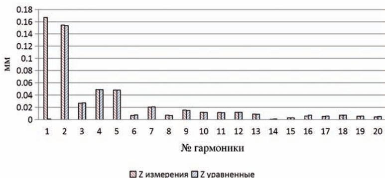
Рисунок 4.27 – График спектрального состава погрешностей измерений знаков сети для вертикального направления варианта сети № 3
