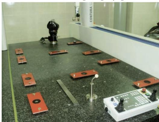
Рисунок 2.21 – Геодезические знаки, закрепленные на плите
