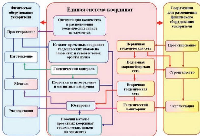
Рисунок 1.28 - Структурная схема геодезического обеспечения этапов создания УНК с учётом технологических связей
