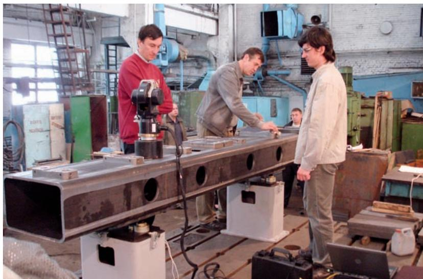
*Подготовка к геодезическим измерениям на гирдере.
