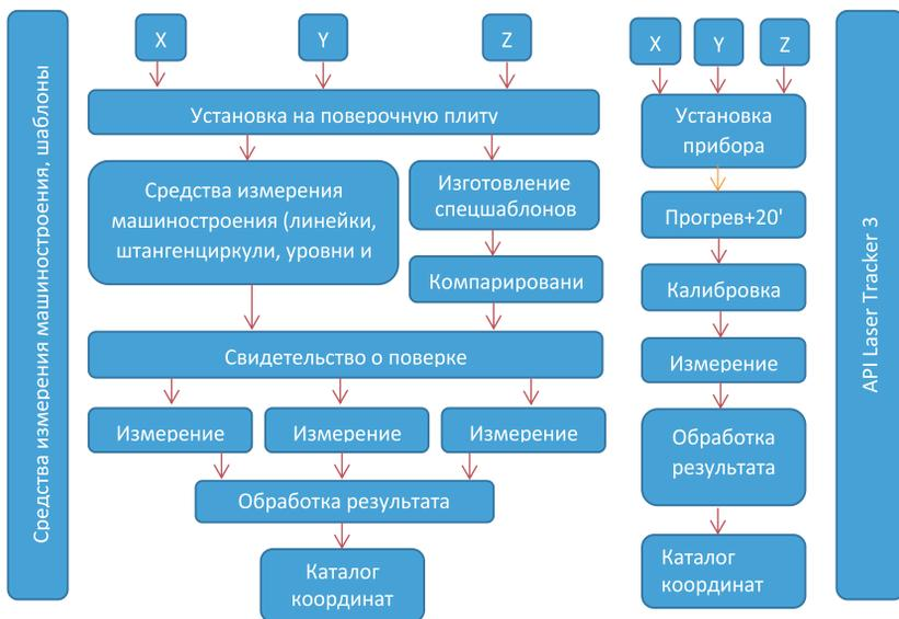
Рисунок 3.1 – Сравнение методик геодезических измерений
