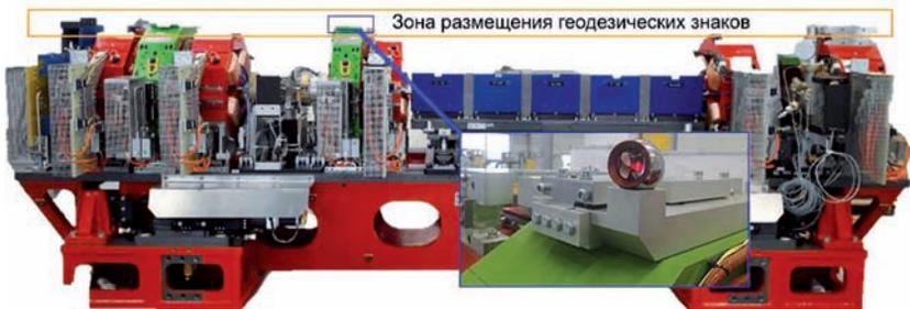
Рисунок 4.1 – Расположение геодезических знаков на элементах основного кольца ESRF-EBS
