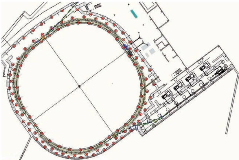
Рисунок 1.22 – Вторичная опорная геодезическая сеть бустера NSLS-II
