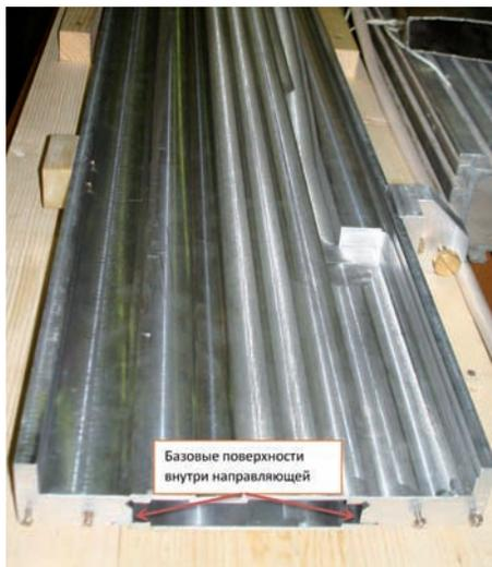
Рисунок 3.11 – Высокоточная направляющая
