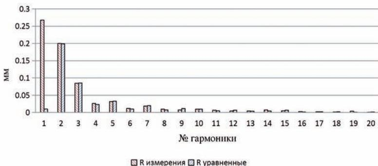
Рисунок 4.23 – График спектрального состава погрешностей измерений знаков сети для радиального направления варианта сети № 2
