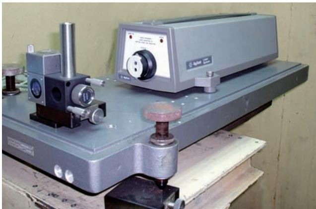
Рисунок 2.6 – Интерферометр Hewlett-Packard 5529A
