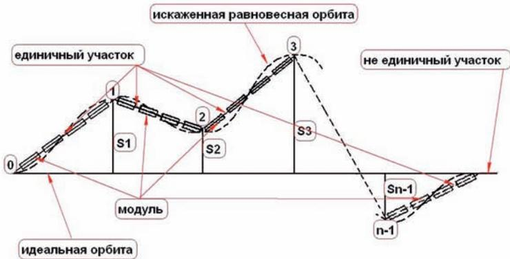
Рисунок 4.10 – Схема построения структуры бустера из единичных участков, состоящих из четырех модулей
