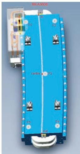
*Рисунок 3.24 – Расположение и название геодезических знаков на дипольном магните.*
