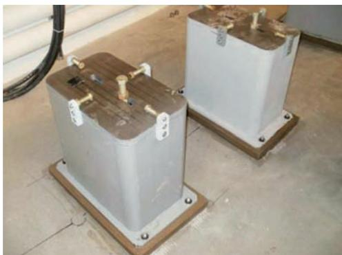
Рисунок 1.26 – Установленные опорные конструкции гирдера относительно вынесенной линии оси
