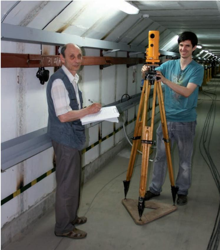
*Нивелирование в тоннеле ускорителя.
